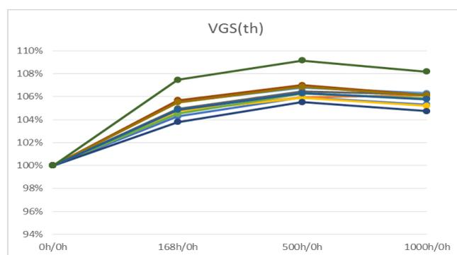
Fig.9. SiC MOSFET parameter stability test
